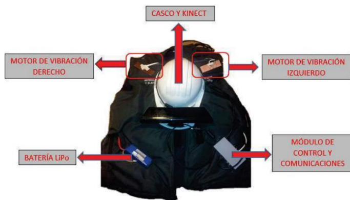
Figura 10. Chaleco y cinturón para orientación y movilidad de personas con discapacidad visual.
