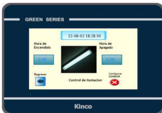
Imagen 17 Ventana Configuración Control de Iluminación SIT
