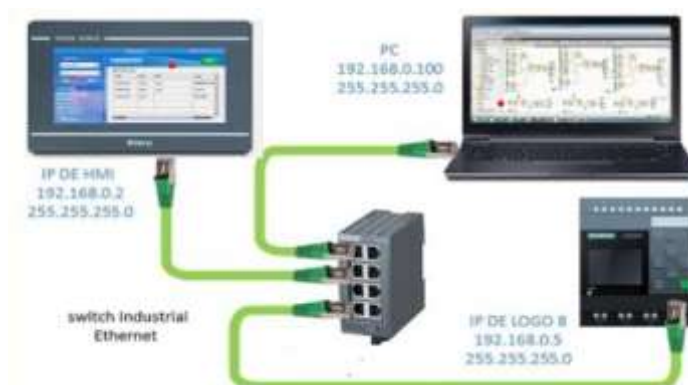
Figura 11 Arquitectura Red LAN Protocolo TCP/IP [20].
