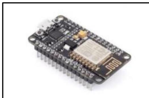
Figura 20. Módulo NodeMCU.
