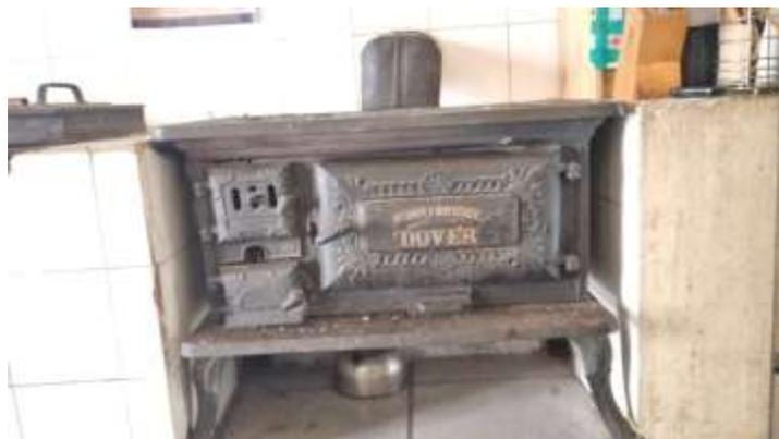
En la foto se muestra cómo funcionaba una cocina antigua a base de carbón en la que en la parte inferior izquierda se colocaba la leña y esta abrigaba los quemadores superiores, la misma contaba con una salida de gases posterior, la misma que estaba conectada a una chimenea.
