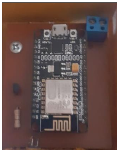
Fig. 42: Módulo para control de televisión por voz. Fuente: (Autor, 2023)
