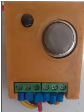
Fig. 32: Sensor de gas y de flama.
