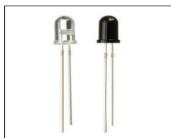
Fig. 20: Fotodiodos infrarrojos emisor (blanco) y receptor (oscuro). Fuente: (Quiñonez, 2020)
