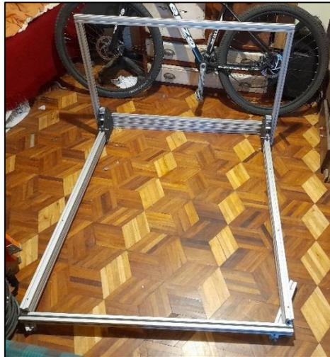
*Nota. La imagen muestra la estructura de la máquina, la misma que es su mayoría está conformada por perfiles de aluminio. Estructura Mecánica, [Fotografía], Autor.*
