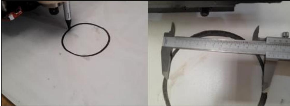
*Nota. Se realizó el grabado de un círculo como se observa en la parte izquierda de la fotografía, con la finalidad de ver la precisión se verificó el diámetro del círculo con un calibrador vernier. [Fotografía], Autor*
