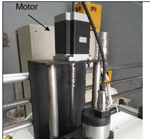
*Nota. En la fotografía se puede apreciar el motor que se encarga del movimiento del eje Z este se encuentra montado sobre una placa metálica y ajustada con tornillo, el eje del motor se une con el tornillo por medio de un acople rígido.*
