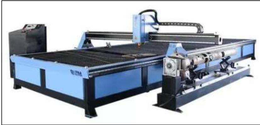
Nota. En la figura presentada se puede observar una cortadora de plasma CNC, siendo esta una variable de máquinas CNC, este tipo de máquinas se usa a nivel industrial para el corte de metales. Cortadora de plasma CNC, Edison Criollo, 2019,
