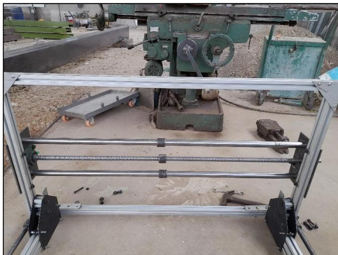
*Nota. La imagen muestra la estructura de la máquina, y la parte inicial de la construcción del eje "X" y del eje "Z", utilizando materiales como placas de acero, chumaceras y varillas de acero de transmisión. [Fotografía], Autor.*
