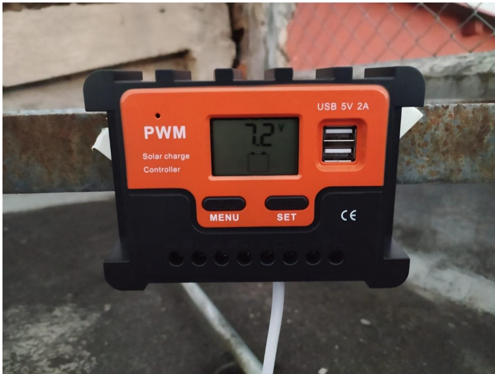
Figura 4.10 Controlador de cargador solar.
