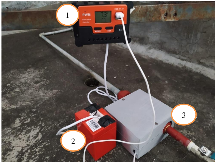
Figura 3.7 Pruebas de campo, (1) cargador solar, (2) Batería, (3) carcasa de protección.
