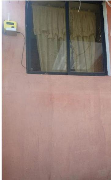
El nodo sensor debe estar ubicado en la parcela, a una altura de 1.5 metros del suelo, fuera del límite de riego del aspersor para evitar que se active el sensor de lluvia.
