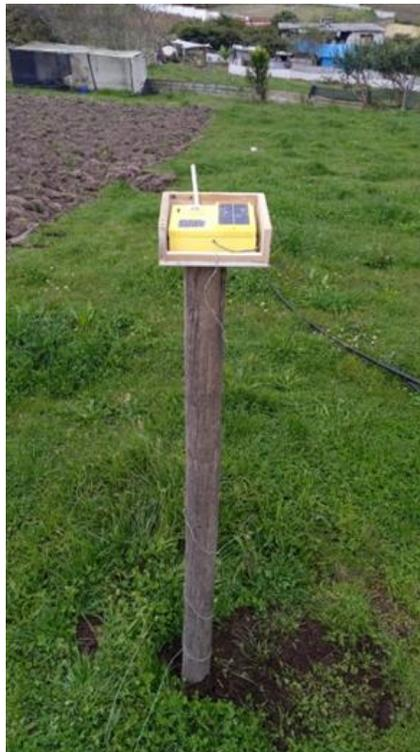
Sin embargo, el sensor de humedad del suelo debe colocarse dentro del límite de riego, tomar en cuenta que el sensor de humedad no se debe introducir por completo en el suelo, hay que considerar el límite de seguridad.
