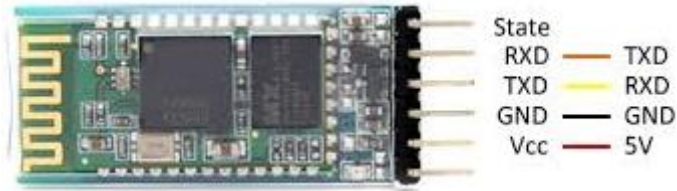
Figura 47. Distribución de pines modulo Hc-05
