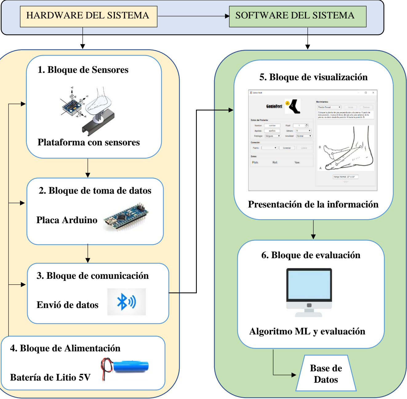
Figura 35. Arquitectura del Sistema
