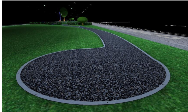
Fig. 3.5. Luminarias de piso en el borde de la ciclovía. Obtenido de simulación en DIALux evo. Autor(2022)
