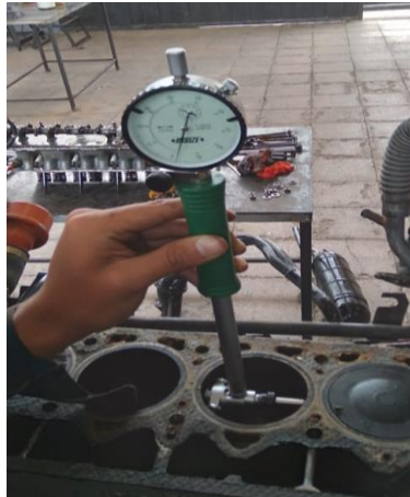
Figura 3.13 Medición de block
