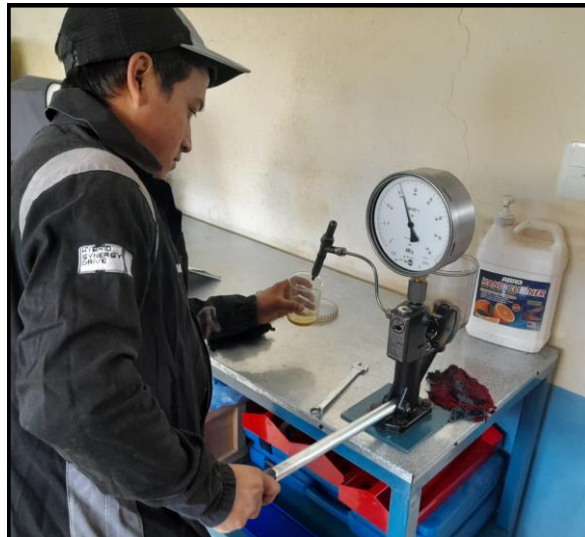
ANEXO 8 Prueba y calibración de Inyectores
