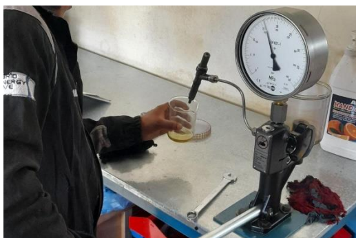
Figura 3.33 Prueba de estanqueidad
