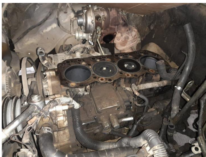
ANEXO 2 Desarmado de la tapa válvulas y culata del motor
