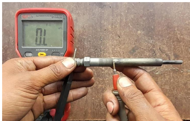
Figura 3.34 Prueba resistencia de bujía de precalentamiento
