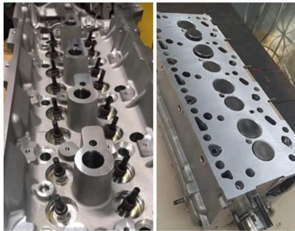
Figura 3.7 Montaje de válvulas en la culata
