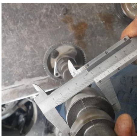
Figura 3.2 Medición de muñón de árbol de levas
