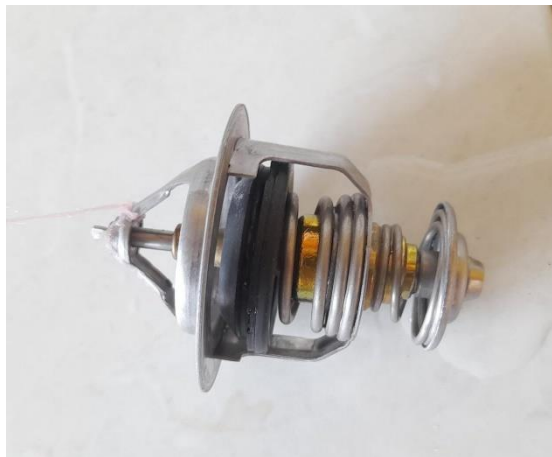
Figura 3.26 Prueba apertura de termostato
