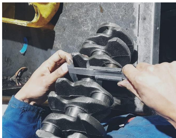
Figura 3.22 Diámetro del muñón cigüeñal – bloque motor
