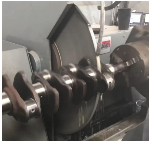
Figura 3.21 Pulida y balanceo de cigüeñal
