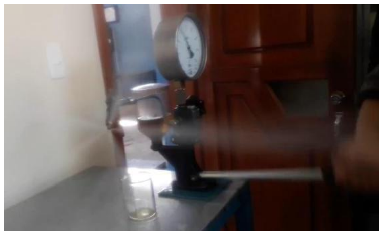
Figura 3.31 Prueba visual de pulverización
