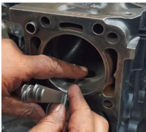
Figura 3.15 Separación de segmentos
