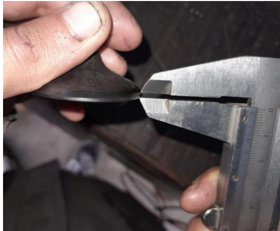
Figura 3.9 Toma de medida grosor cabeza de válvula
