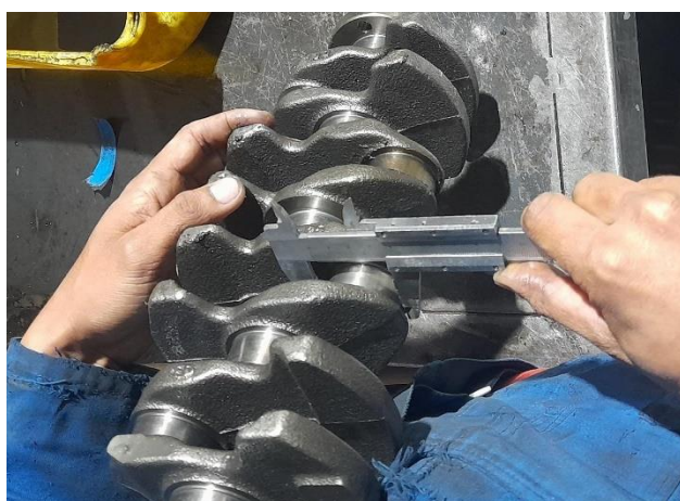
Figura 3.23 Diámetro de muñón cigüeñal – biela
