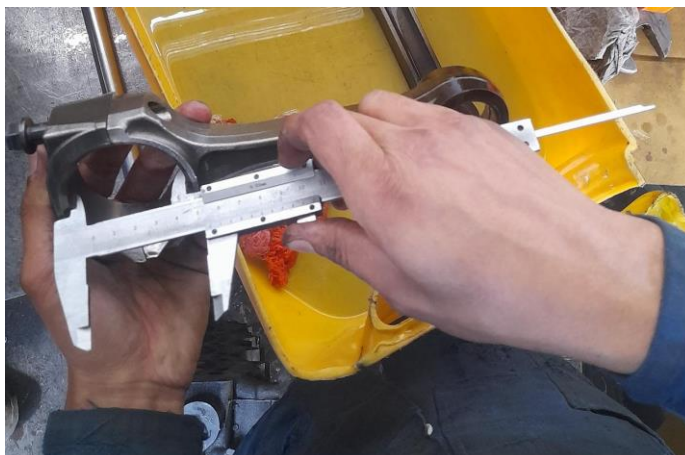
Figura 3.19 Toma de medida del diámetro interior del muñón de biela – cigüeñal
