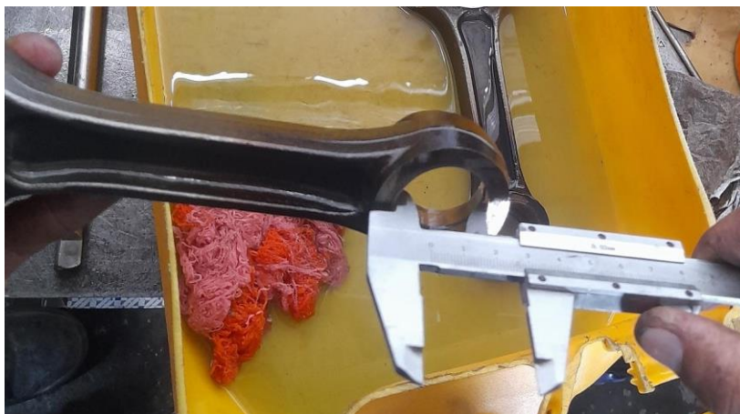
Figura 3.20 Toma de medida del diámetro interior biela - bulón
