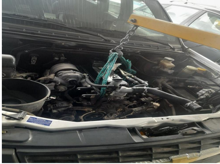
ANEXO 7 Montaje del motor dentro de la camioneta
