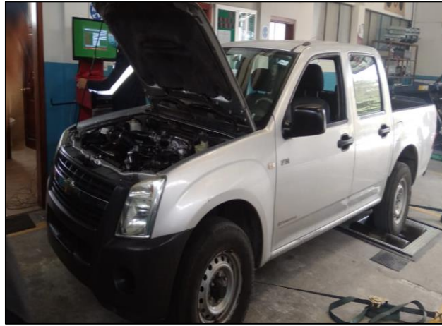
ANEXO 9 Prueba en el dinamómetro
