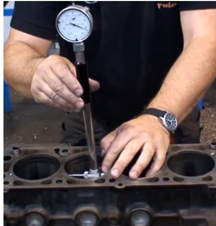
Figura 2.1 Toma de medidas y diagnóstico de cilindros
