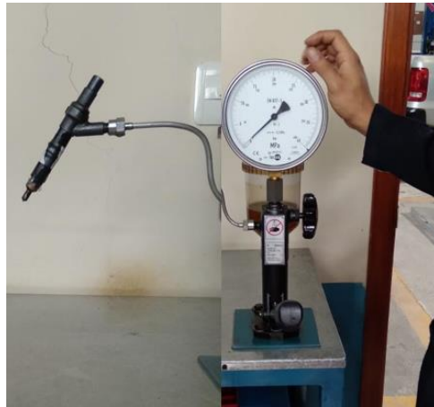
Figura 3.30 Prueba de Inyectores
