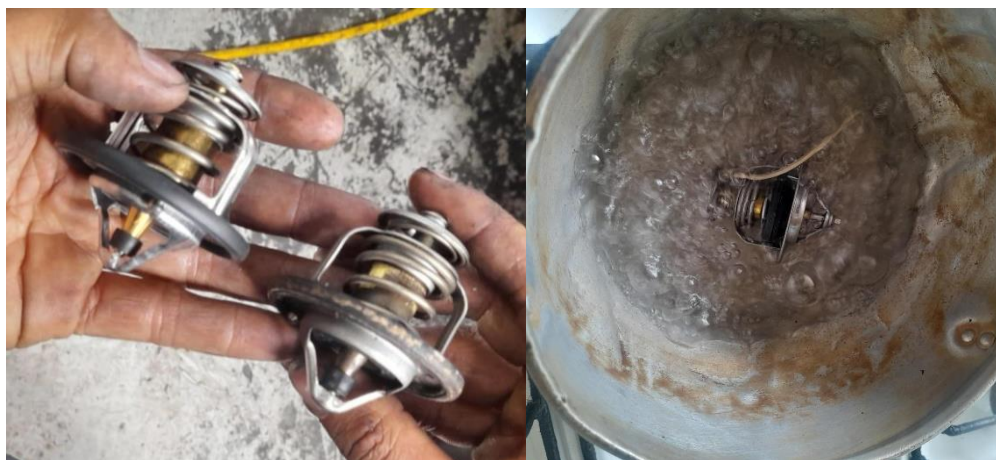
Figura 3.25 Termostato Motor Isuzu 4JH1 (nuevo - usado), Prueba apertura de termostato
