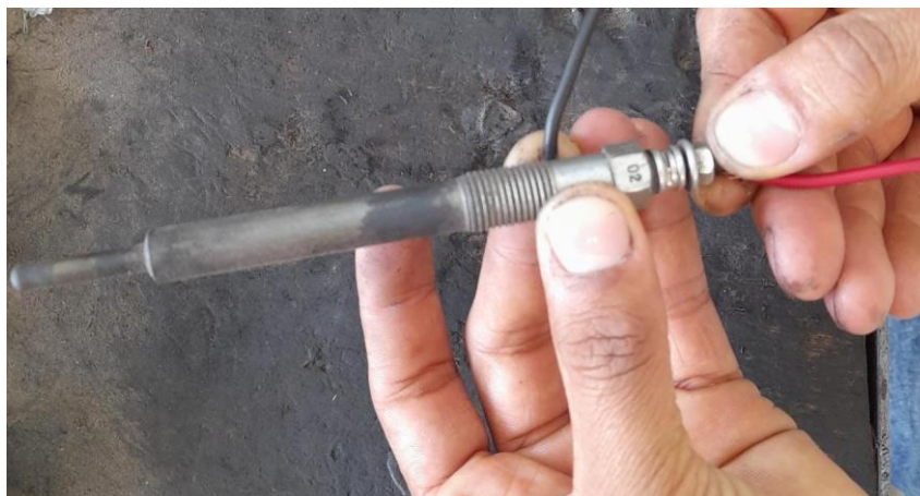
Figura 3.35 Prueba incandescencia de bujía de precalentamiento
