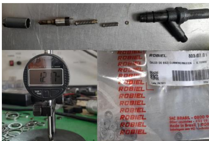
Figura 3.32 Calibración de inyectores
