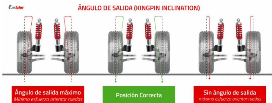
Figura 1.12 Ángulo de Salida ( kingpin ) (Carluder 2021)
