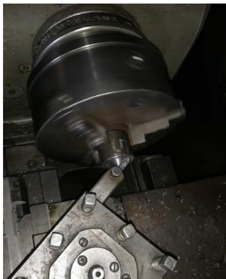
Figura 3.54 Refrendado de las bases de los discos de freno mediante torno de precisión
