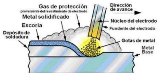
Figura 2.2 Elementos que intervienen en el proceso de soldadura smaw Fuente: (Legña Oyacato y Ochoa Peña 2021)
