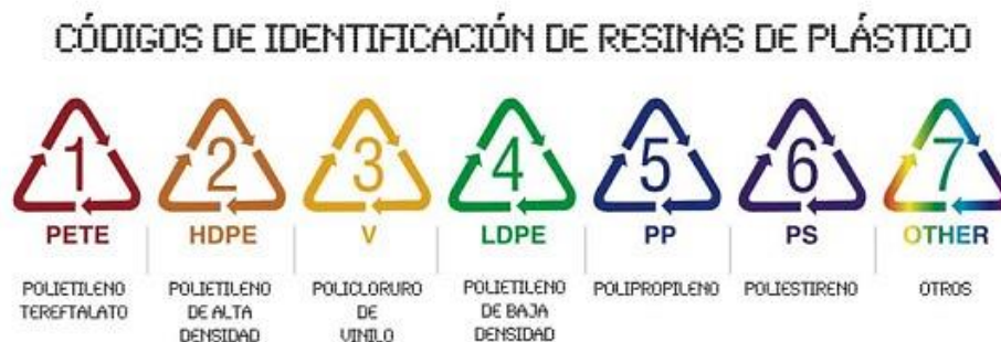
Figura 7 Clasificación de las resinas de plástico
