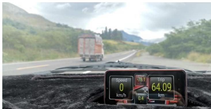
Figura 2.12 Proceso de obtención de datos en el vehículo de prueba
