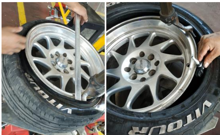
Figura 2. 17 Vulcanizacion e instalación de los sensores
