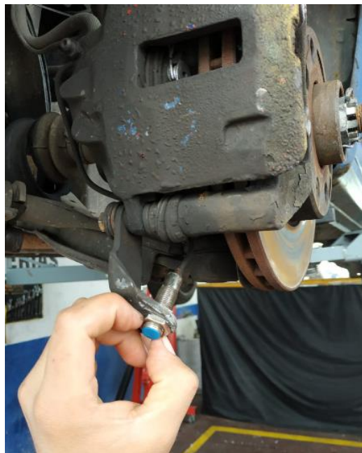
Figura 2. 19 Instalación sensor inductivo
