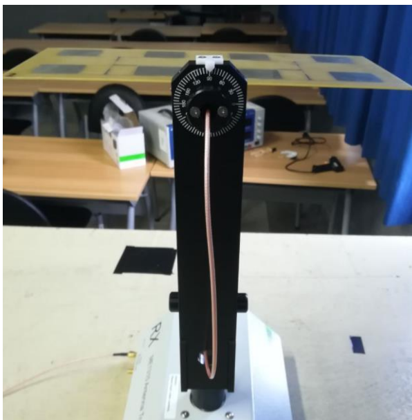
Figura 5.18. Perilla de precisión para girar la antena en el módulo RX.
