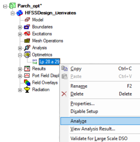
Ilustración D.5. Puesta en marcha del barrido paramétrico con herramienta “Parametrics” en HFSS.
