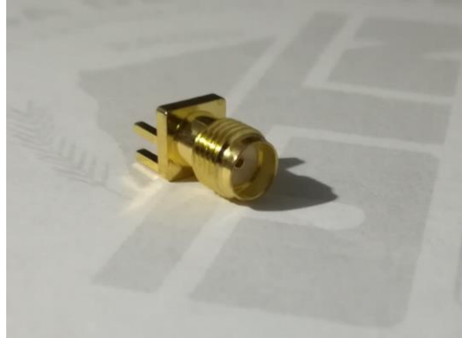
Figura 3.4. Conector SMA tipo hembra de montaje lateral de 50 \Omega .
