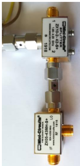
Ilustración E.7. Conexión entre el MEZ y el DIV mediante un adaptador SMA M-M.
