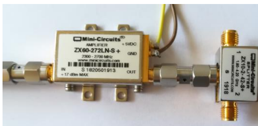
Ilustración E.6. Conexión del DIV al AMP mediante un adaptador SMA M-M.
