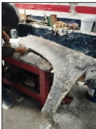
Figura 2.30 Aplicación de cera en el molde
