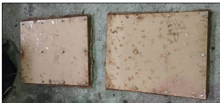
Figura 2.22 Sellado de tableros
