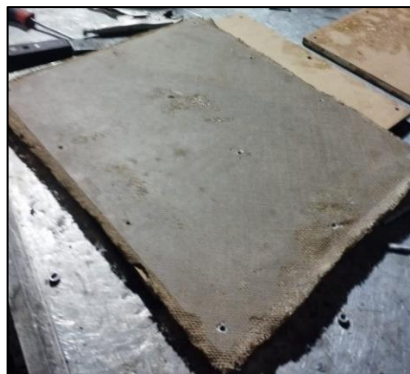
Figura 2.23 Desmolde de tableros
