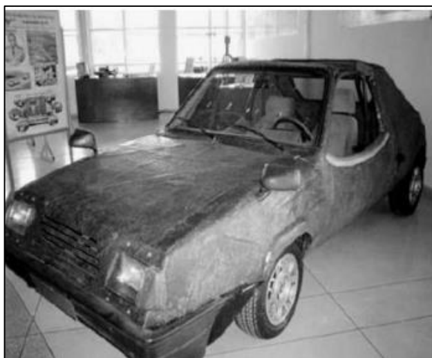
Figura 1.9 Vehículo construido con fibra de yute Fuente: (Dávila, José Luis et al., 2011, pág. 220).
