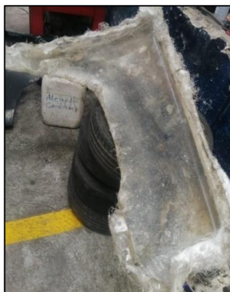
Figura 2.29 Molde de guardabarros Mazda BT50
