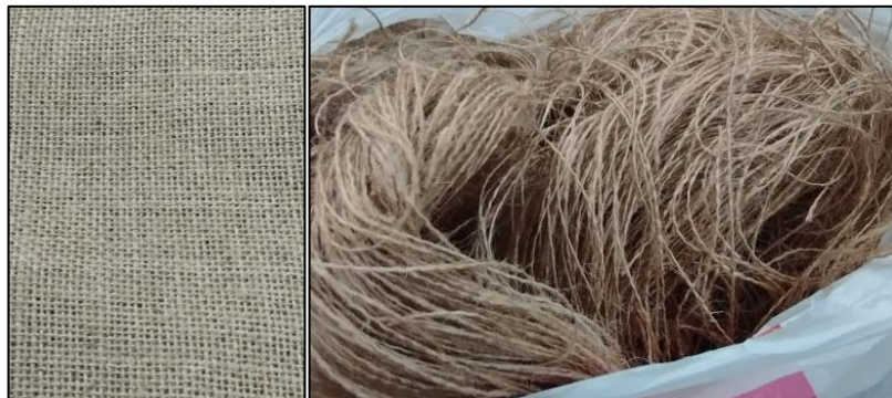
Figura 2.11 Fibra suelta y fibra tejida
