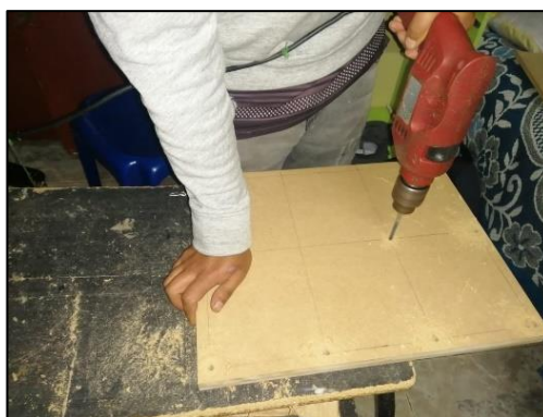
Figura 2.18 perforación de tableros.
