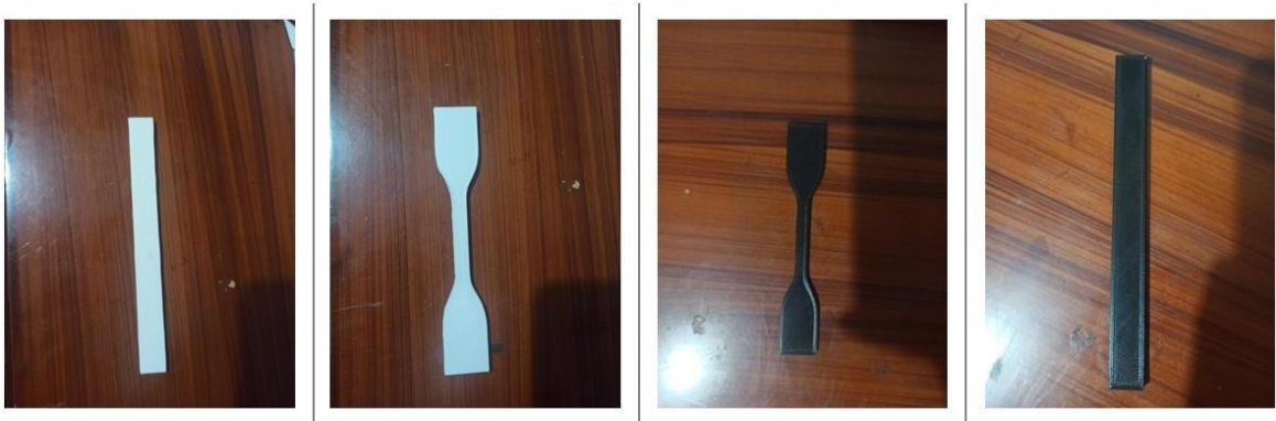
Figura 3.7 Probetas impresas para ensayos de tracción ASTM D638 y flexión D790 (Autoría propia)
