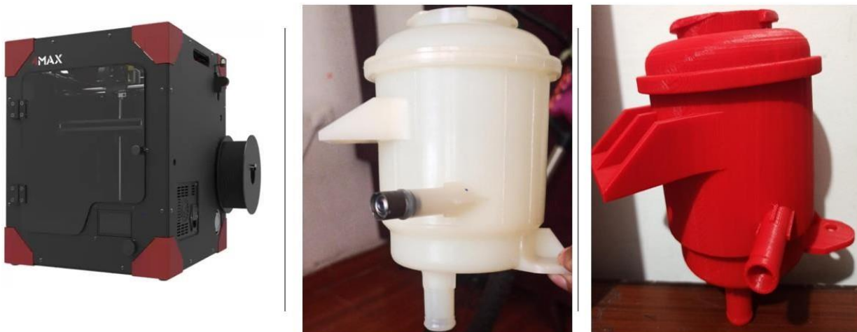
Figura 3.5 Prototipo del depósito hidráulico del Chevrolet Sail 2010 y su original (Autoría propia)
