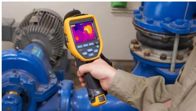
*Nota.* La termografía se usa para la detección de fallas eléctricas a nivel industrial, ayuda a los técnicos en mantenimiento, además que se lo puede usar en muchas áreas. Fuente: Terotecnic (2021).
