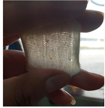
C. Rotura de la probeta contra luz.
