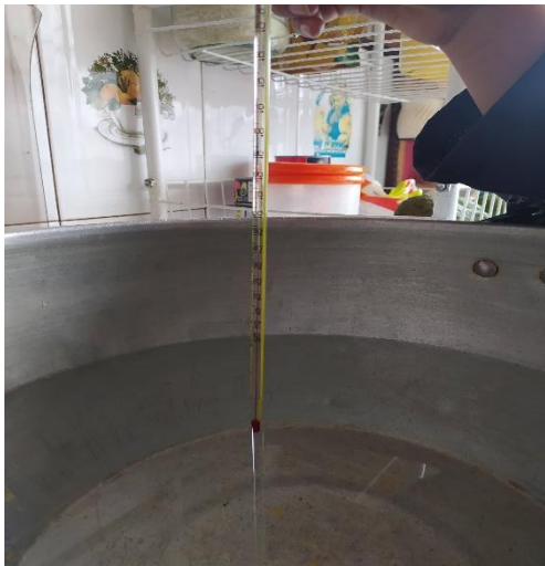
Control de temperatura para neutralizado
