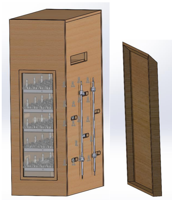
Figura 2.21 Modificación de la estructura de la incubadora
