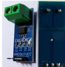
Fig. 76. Módulo de sensor de corriente. Recuperado de (Allegro MicroSystems, 2022).
