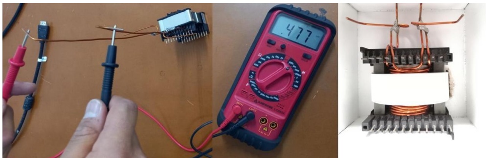
Fig. 86. Diseño y medición del inductor. Fuente: Autor.
