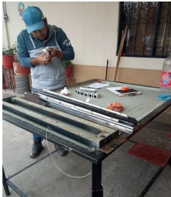
Figura 47 Limpieza y preparación para pintura Fuente: Autoría propia
