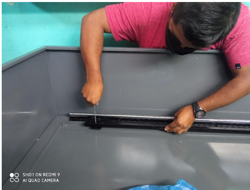
Figura 102 Montaje de las cremalleras en mesa de trabajo Fuente: Autoría propia
