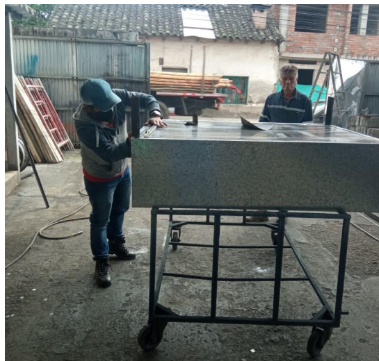
Figura 44 Armado de la mesa de trabajo con cubierta Fuente: Autoría propia
