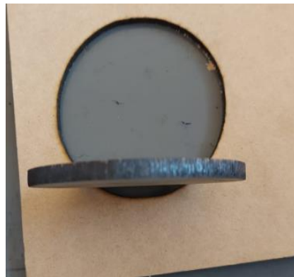
Figura 89 Resultada del corte en MDF con los parámetros del caso 1. Fuente: Autoría propia
