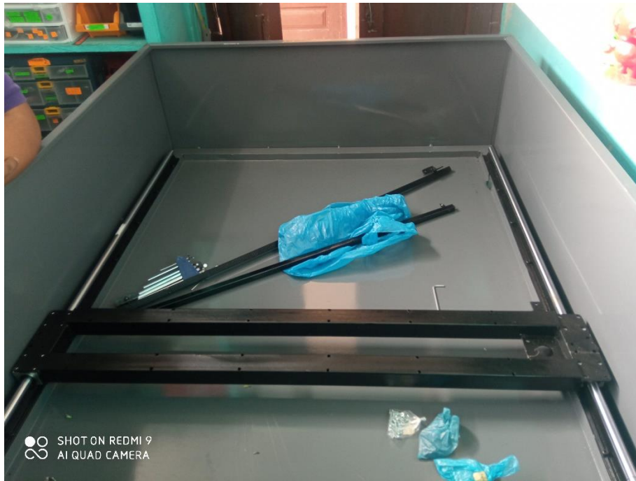
Figura 101 Montaje del carro móvil sobre las guías del eje Y Fuente: Autoría propia
