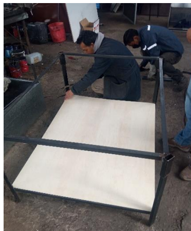
Figura 94 Construcción de la base de la mesa de trabajo Fuente: Autoría propia
