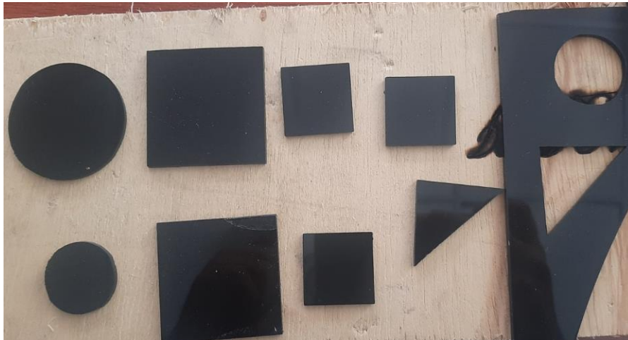
Figura 91 Resultada del corte en acrílico con los parámetros del caso 1. Fuente: Autoría propia
