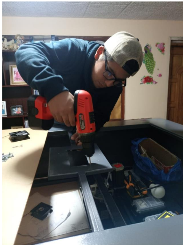
Figura 106 Montaje de la cubierta de la maquina CNC Fuente: Autoría propia
