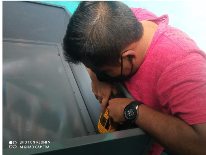
Figura 99 Perforación para el montaje de guías lineales Fuente: Autoría propia
