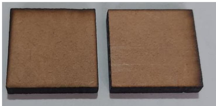
Figura 90. Resultada del corte en MDF con los parámetros del caso 2. Fuente: Autoría propia
