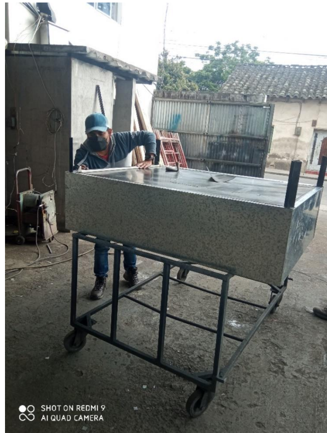
Figura 96 Lijado del bastidor Fuente: Autoría propia
