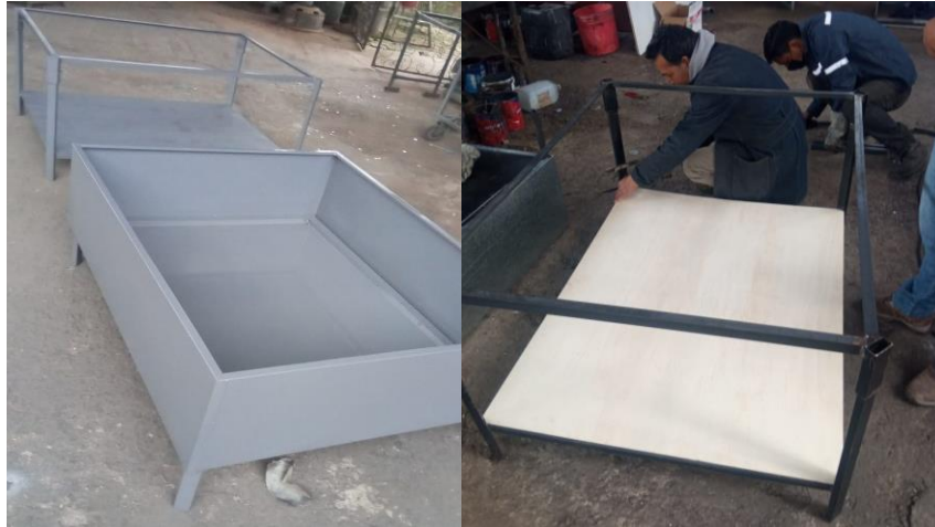
Figura 43 Bastidor de máquina CNC durante proceso de fabricación. Fuente: Autoría propia
