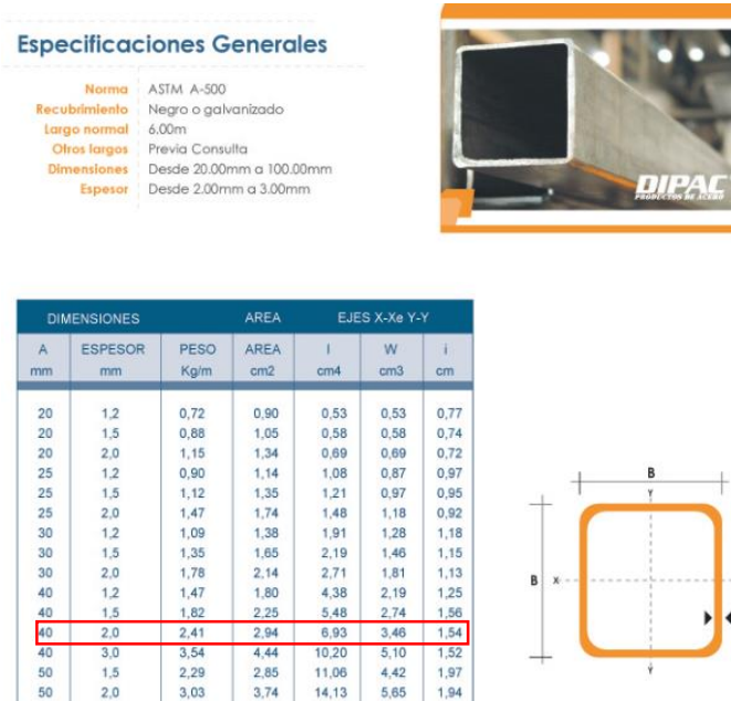
Figura 26 Propiedades geométricas de perfil Tubo cuadrado 40 x 2 mm
