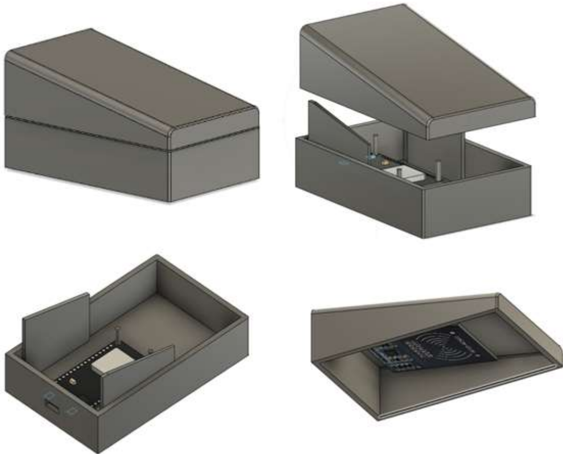
Figura 48 Diseño carcasa prototipo NFC
