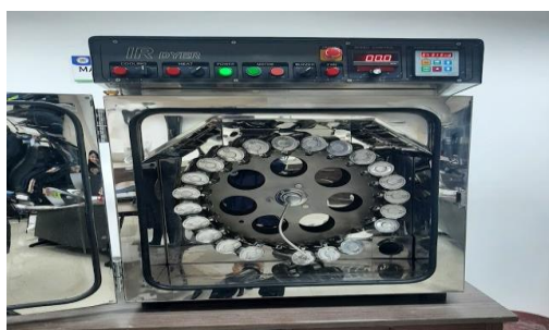
Anexo 11. Ensayo del lavado bajo la norma AATCC 61: 2013
