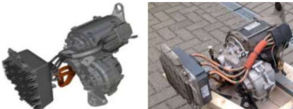
Figura 2.4 Motor eléctrico, inversor y reductor del Renault Twizy
