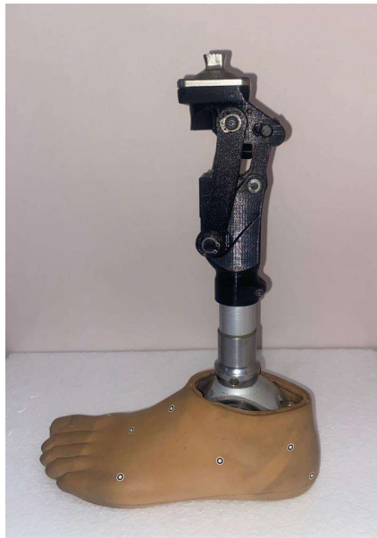
Figura 4.35 Prototipo de prótesis de rodilla en su segunda posición.
