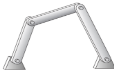
Figura 2.5 Mecanismo de cadena cerrada [25].
