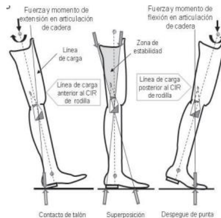
Figura 2.8 Diagrama de estabilidad del mecanismo policéntrico de cuatro barras. [30]
