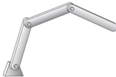
Figura 2.4 mecanismo de cadena abierta [25].
