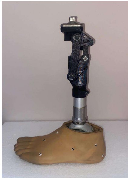
Figura 4.34 Prototipo de prótesis de rodilla en su primera posición.
