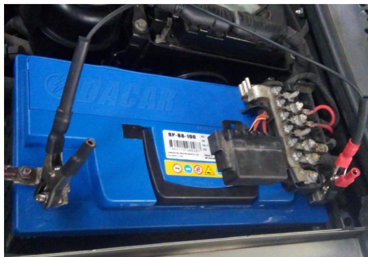
Figura 2.11 Conexión de BOSCH FSA 740 a la batería
