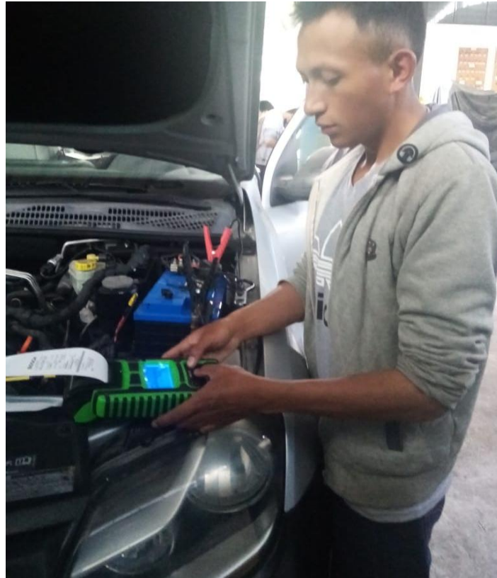
Figura AIII.2. PRUEBAS CON BOSCH BAT 135
