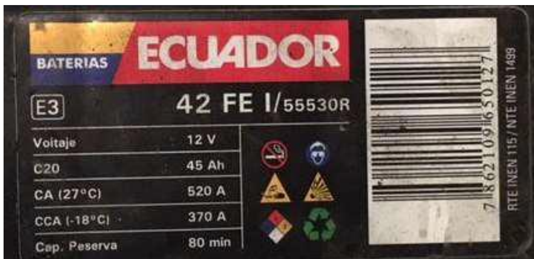
Figura 1.20 Rotulado de una Batería plomo – ácido. (Guevara, 2017)
