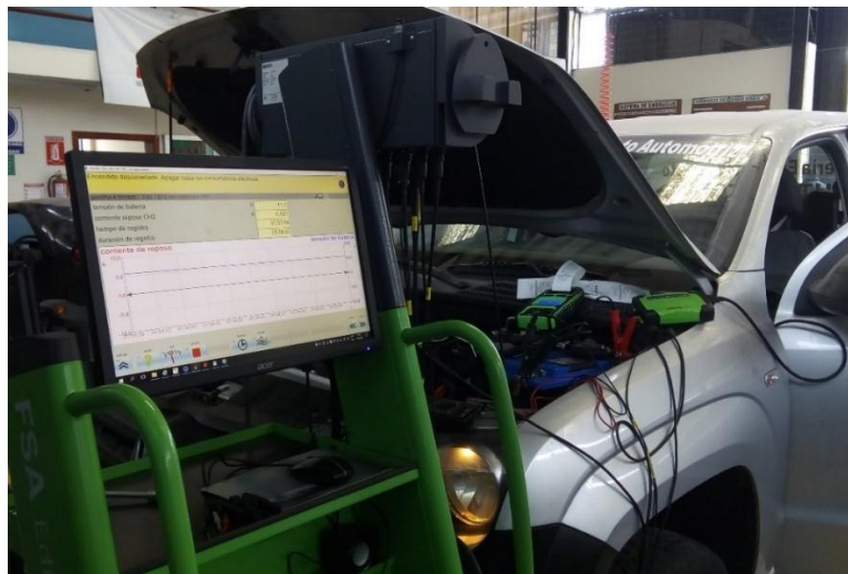
Figura 2.18 Comprobación de la Batería con BOSCH FSA 740
