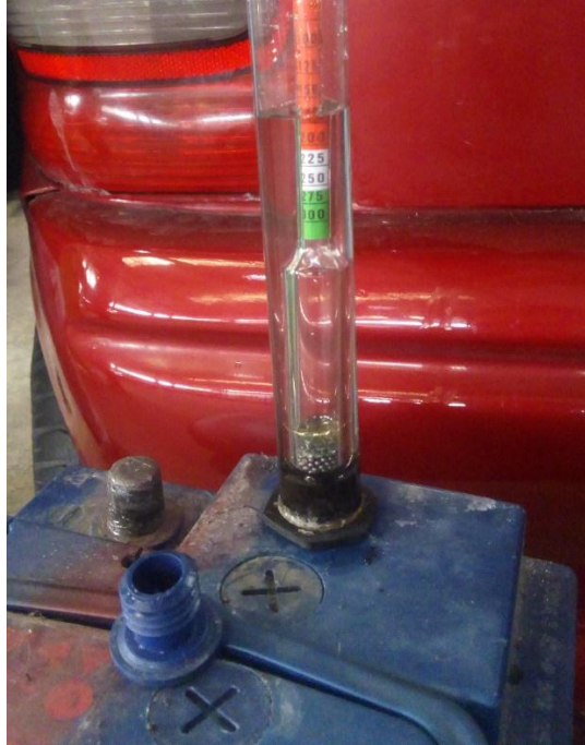
Figura 2.25 Medición de la Densidad del electrolito.
