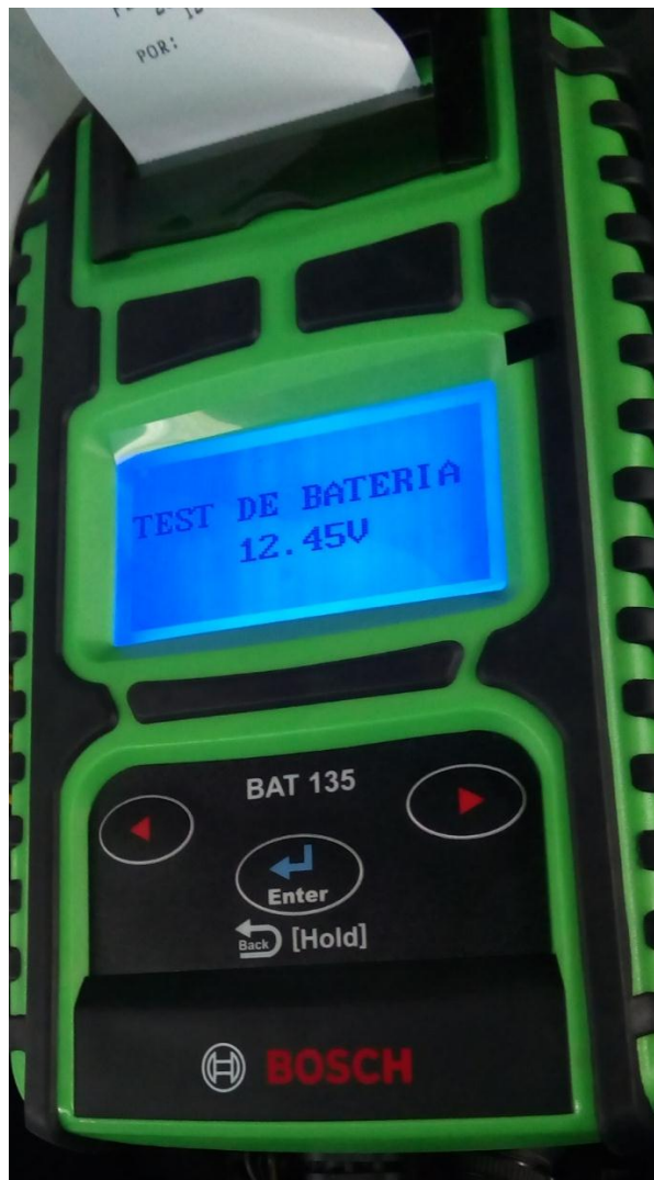
Figura 3.6 Voltaje Inicial de Batería con BOSCH BAT 135.
