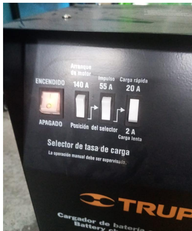
Figura AI.4. CARGADOR DE BATERÍAS
