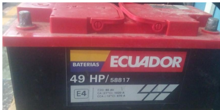
Figura 1.13 Vista frontal de una batería plomo – ácido
