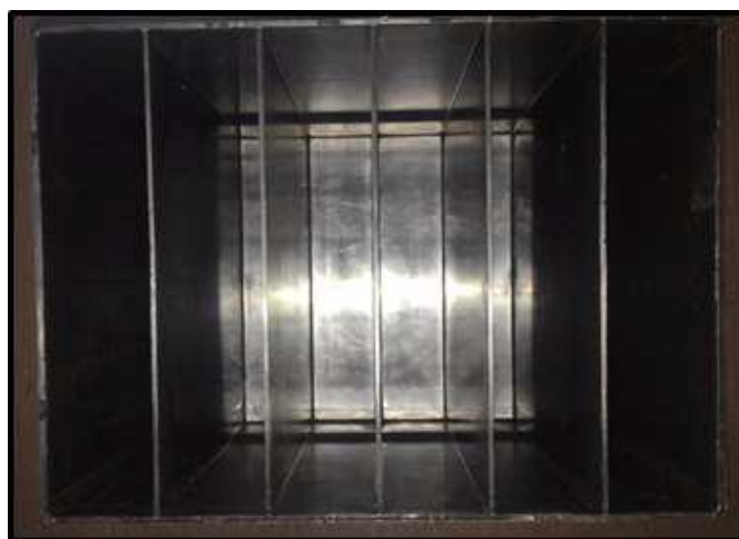
Figura 1.14 Vista de las celdas vacías de una batería plomo – ácido (Guevara, 2017)
