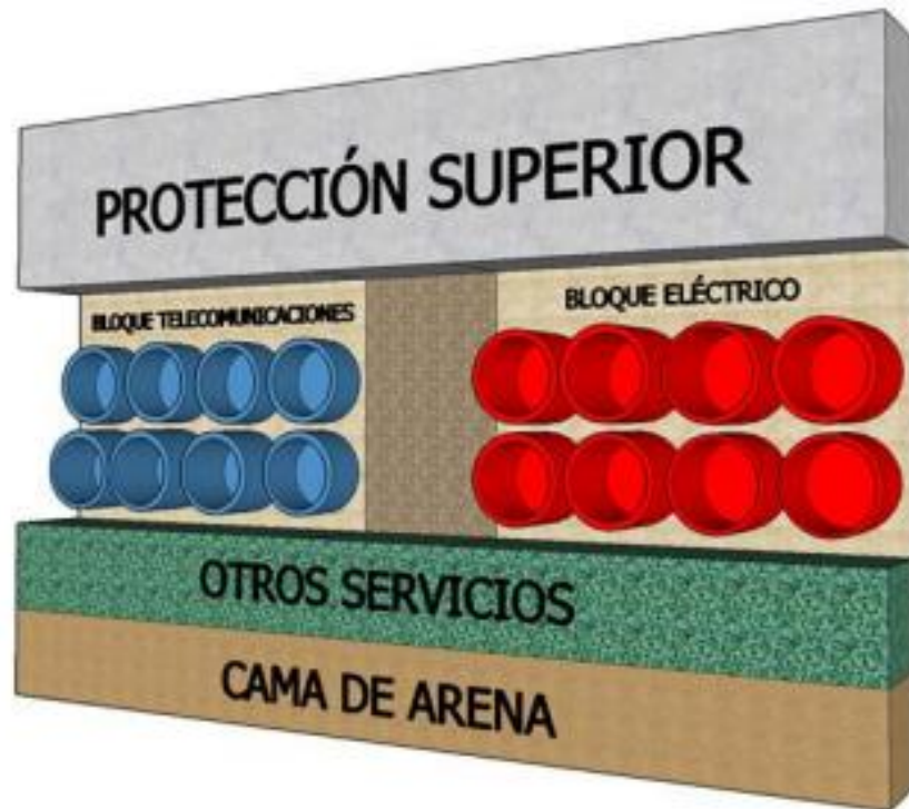
Figura 51. Distribución de los servicios soterrados
