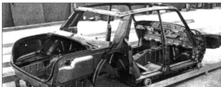
Figura 1.4 Estructura autoportante del Pontiac Fiero
