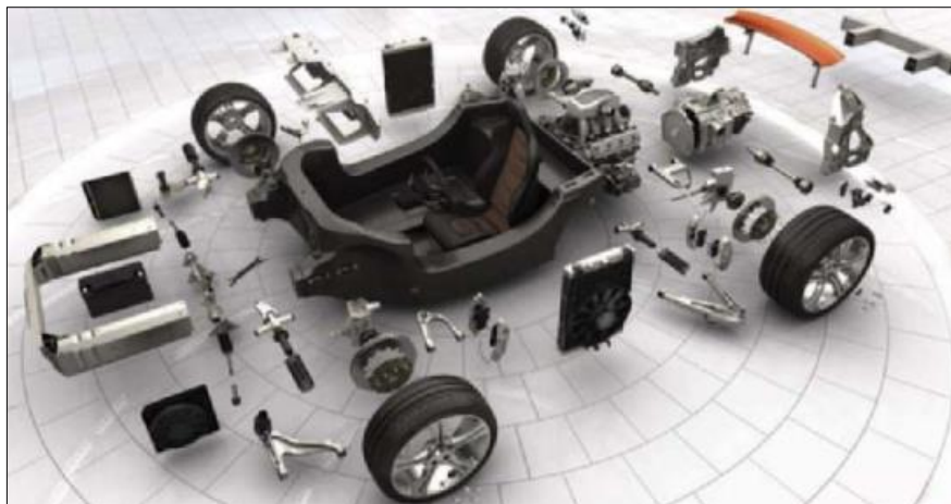
Figura 1.6 Prototipo de una estructura a base de fibra de carbono
