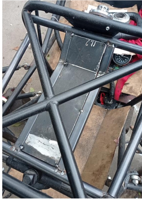
Figura 4. 7 Soportes de anclajes de amortiguadores
