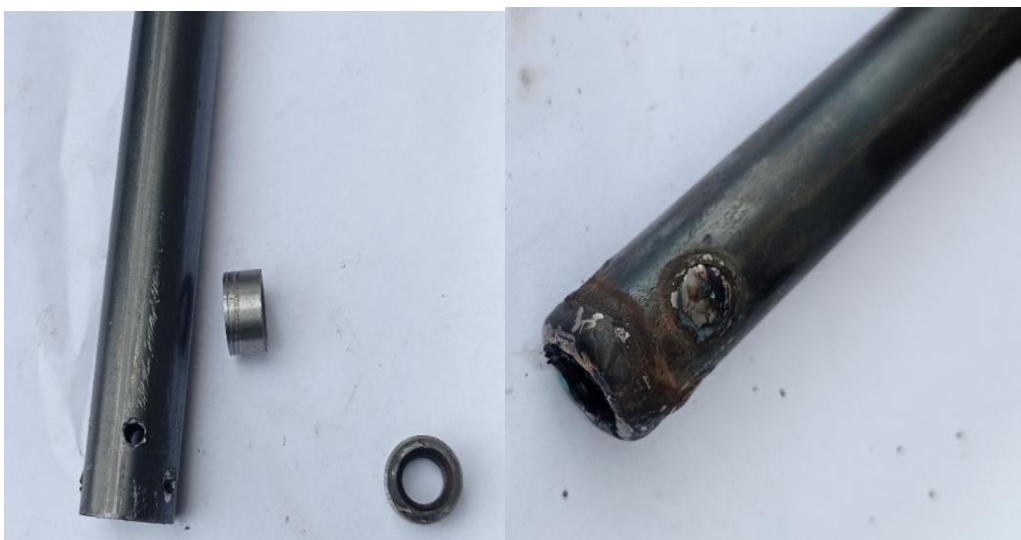
Figura 4. 12 Soldadura de barra push rod
