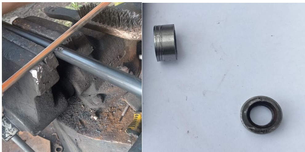
Figura 4. 11. Corte de tubo para barra push
