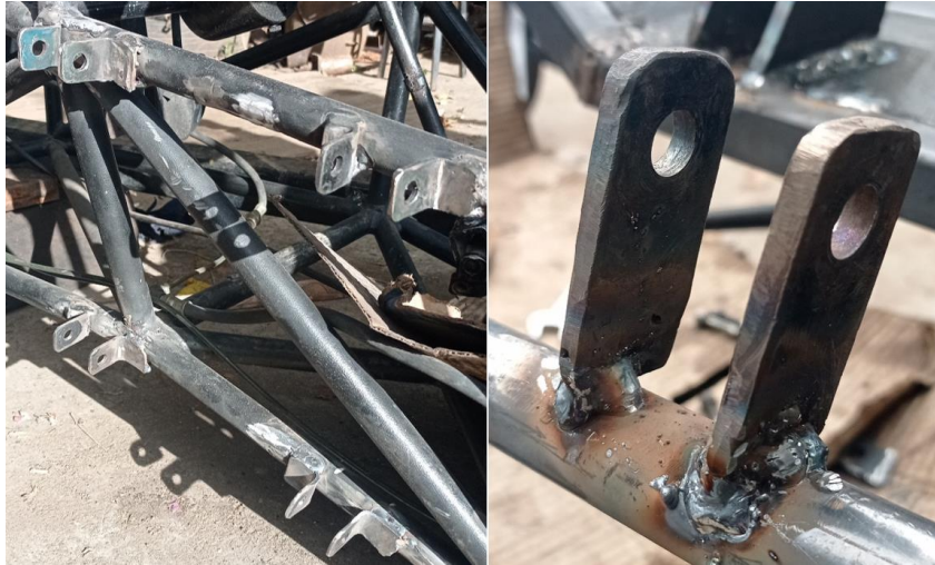
Figura 4. 10. Soldadura de anclajes del brazo y rocker de la suspensión
