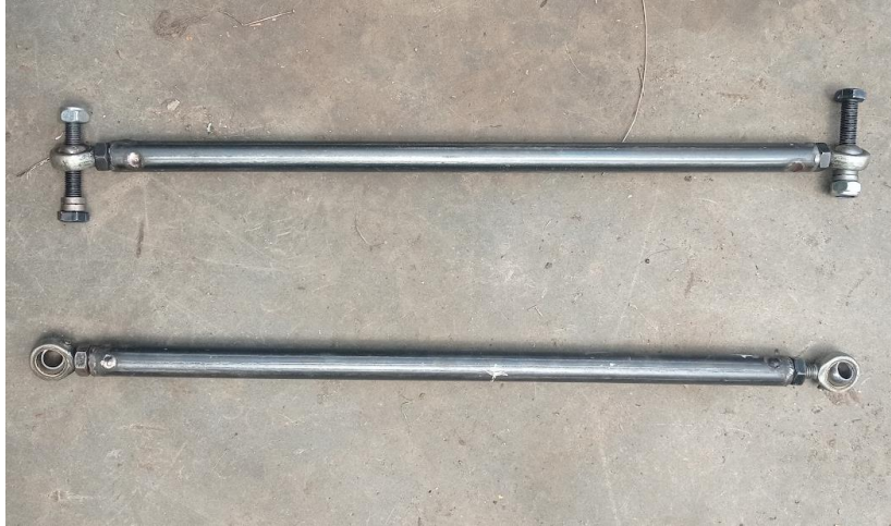
Figura 4. 13 Barra push rod terminada
