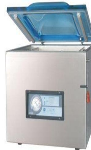
Voltaje de 110-220V. Presión de vacío máxima 1KPa. 2 barras de sellado. Dimensiones: 65x57x101cm. Longitud de sellado 50cm.
