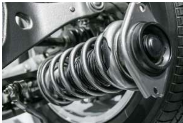
Figura 1.7 Muelles de suspensión (Platas, 2020)
