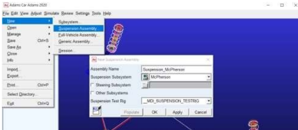
Figura 2.28 Creación de la Plantilla McPherson
