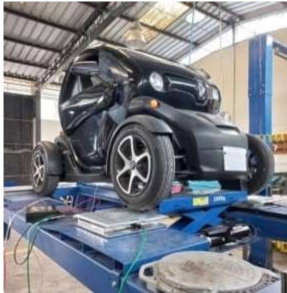
Figura 2.15 Instalación de balanzas en ruedas
