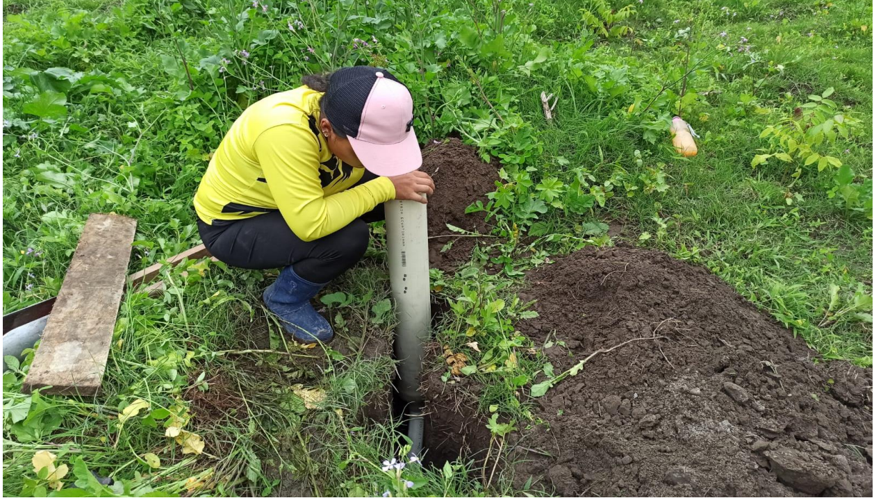
Anexo 4. Instalación de instrumentos para medir la infiltración.
