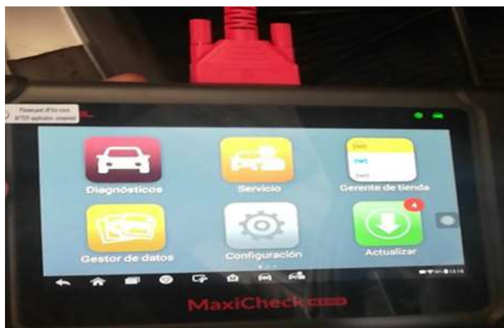
Figura 2.18 Conexión del escáner Maxi Check 808
