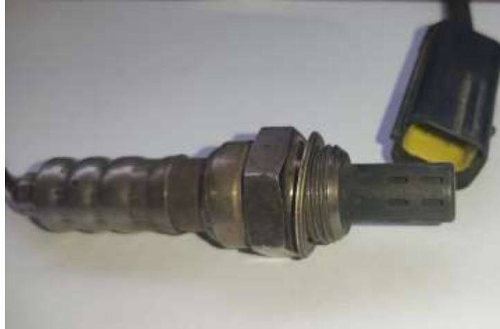
Figura 2.5 Sensor de oxígeno del vehículo Spark LT
