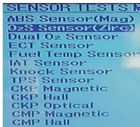
Figura 2.31 Menú Sensor Tests del osciloscopio OTC 3840F
