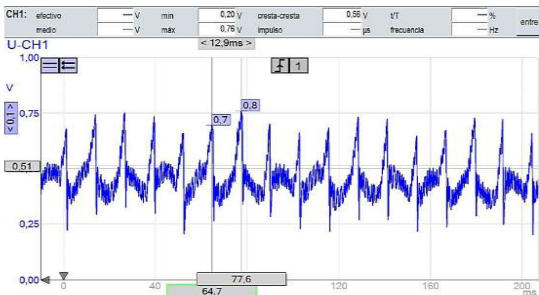
Figura 3.21 Señal O 2 extracción filtro de aire a 2500 rpm en FSA-740
