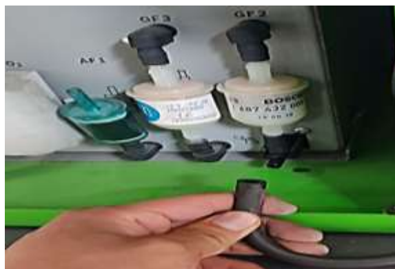
Figura 2.44 Desconexión de manguera de gases de sonda
