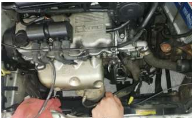
Figura 2.35 Conexión del canal CH1 del osciloscopio del FSA-740
