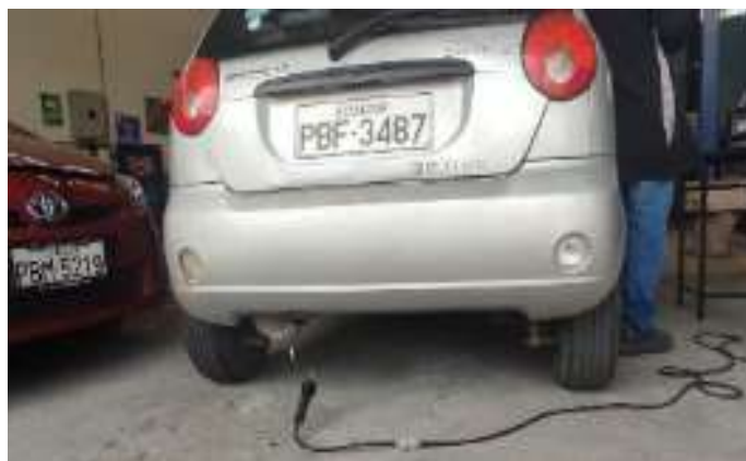
Figura 2.46 Conexión de la sonda al tubo de escape
