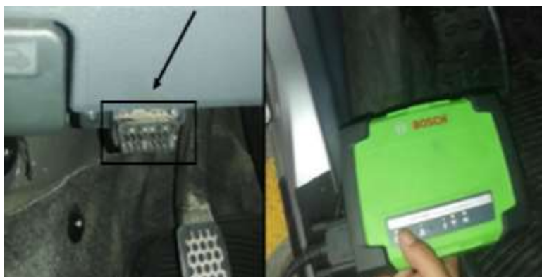
Figura 2.22 Conexión del escáner KTS 560
