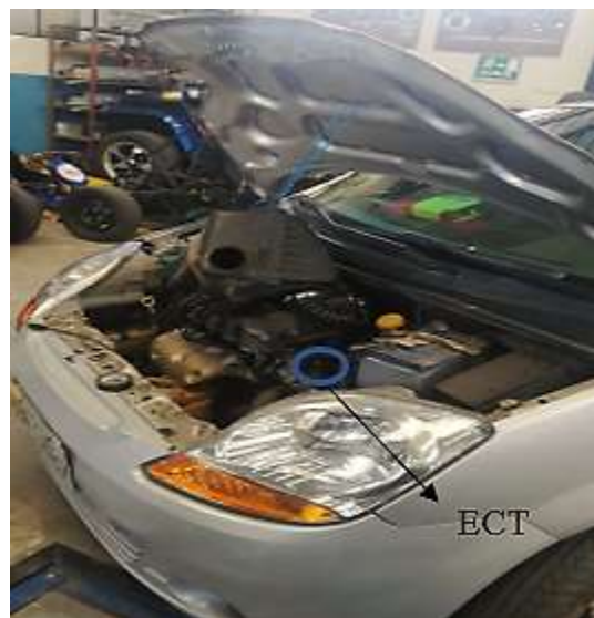
Figura 2.3 Ubicación específica del sensor ECT
