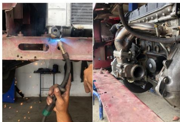
Figura 3.22 Condiciones finales de la implementación del múltiple del sistema de escape
