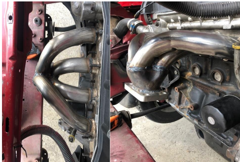
Figura 3.21 Imagen del proceso de construcción e instalación del múltiple de escape
