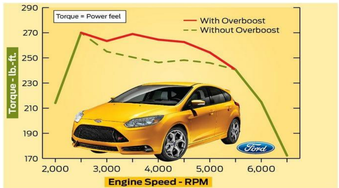
Figura 1.6 Variación de rendimiento de motores a partir del uso de sistemas overboost
