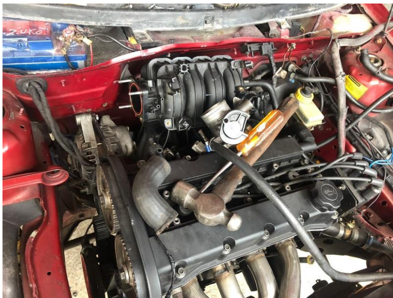
Figura 3.26 Colocación de múltiple original del vehículo (Aveo)
