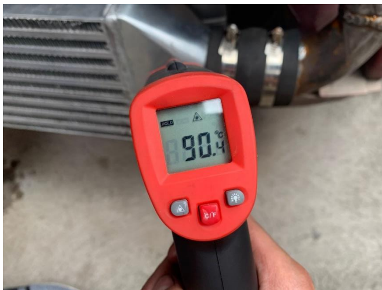
Figura 3.14 Temperatura de entrada intercooler.
