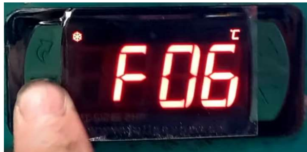
Figura 3.26 Configuración del dispositivo diferencial de temperatura.
