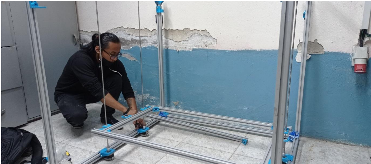
Figura 3.2 Montaje del eje Z y varillas roscadas
