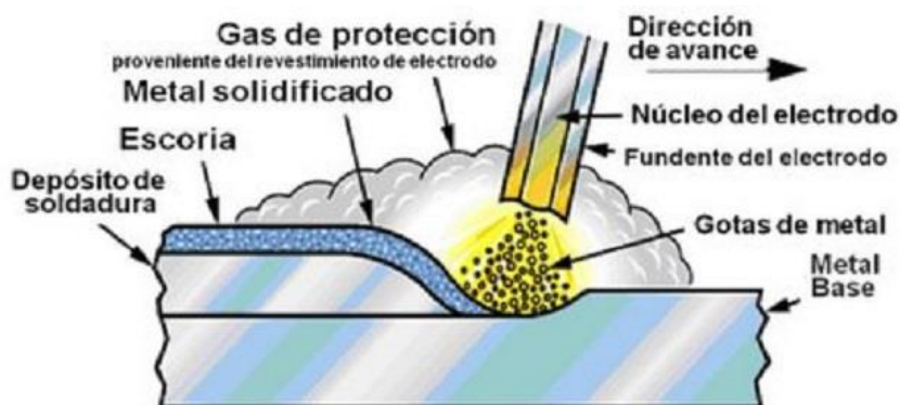
Figura 6 Función del electrodo revestido (Royo, 2014)
