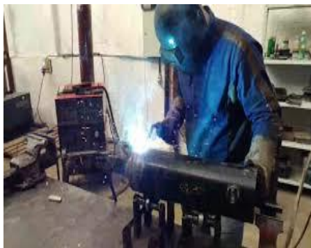
Figura 11 Soldadura de cilindros Hidráulicos
