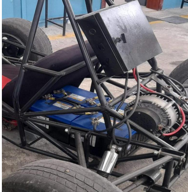
Figura 24 Ubicación de baterías en el vehículo
