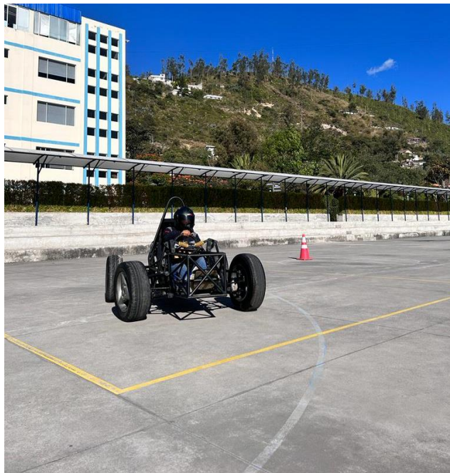
Figura 26 Prueba de autonomía con baterías de plomo
