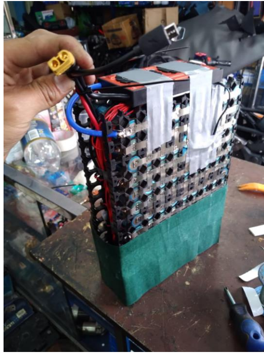
Anexo A Construcción de banco de baterías de litio
