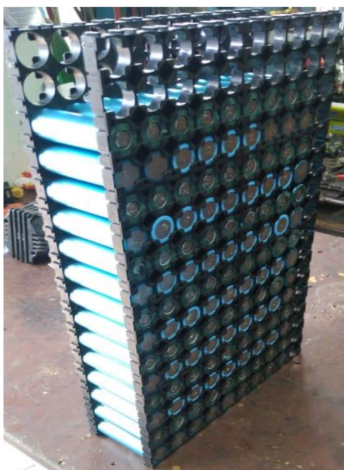
Figura 16 Banco de baterías con separadores
