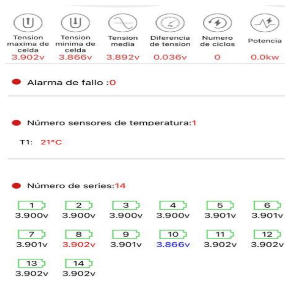
Figura 20 Verificación de carga en las series del banco de baterías de litio
