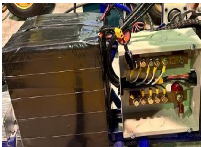
Figura 22 Ubicación de baterías de litio en el vehículo
