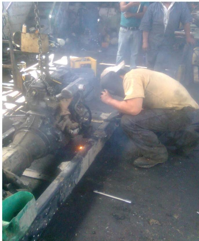
Fig. (45) Montaje del motor en el chasis en el piso previo a la aplicación, (Manuel Guerra, Creacion de la maqueta, 2012)
