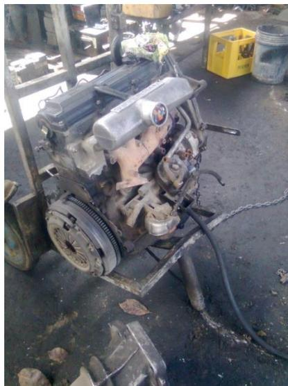
Fig. (40) Motor diesel Kia Besta a reparar, (Manuel Guerra, Torque de Dial, 2012)
