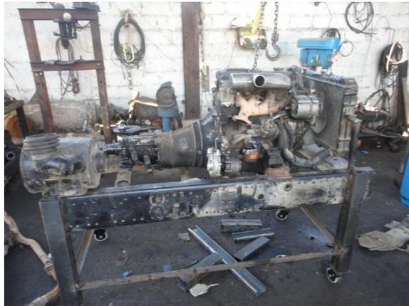
Fig. (47) Colocación de los aditamentos del motor en la maqueta didáctica, (Manuel Guerra, Creacion de la maqueta, 2012)
