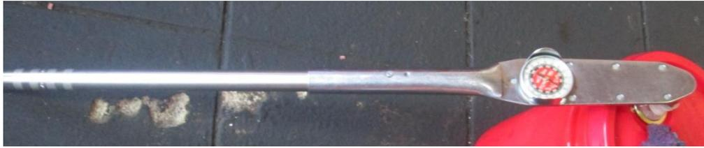
Fig. (43) torque de dial utilizado para el apriete, (Manuel Guerra, Torque de Dial, 2012)
