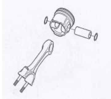
Figura (14) bulón sujetado entre el pistón y la biela, (Kia, Corporacion, 2004)(pg. Em-67)
