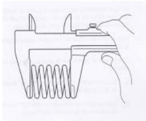
Fig. (24) disposición del muelle de válvula del motor Kia Besta, (Kia Corporacion, 2004) (pg. Em-34)
