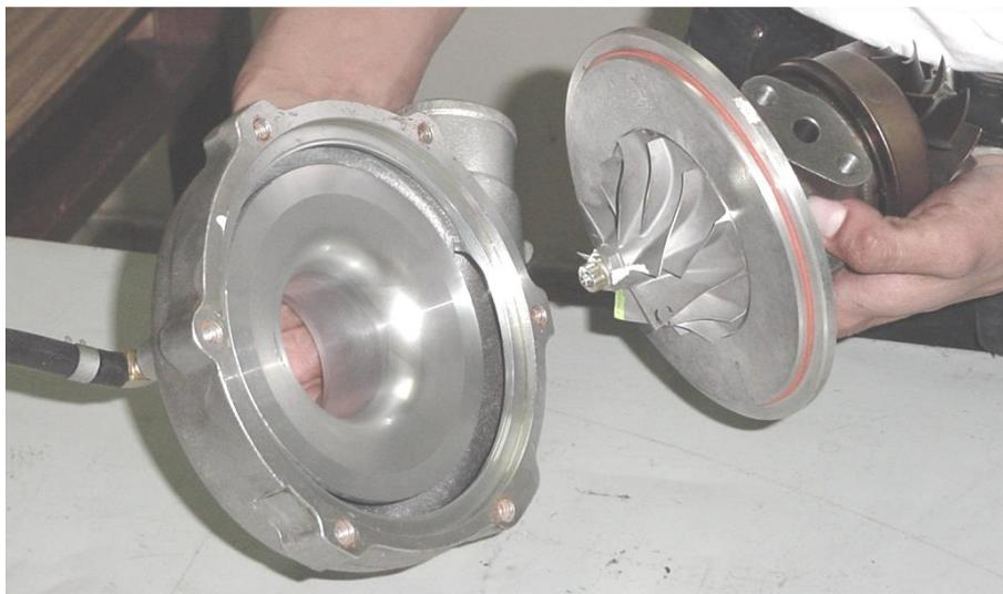
Fig. (30) rodete de admisión (derecha) y Caracol de admisión o compresor (izquierda) de un turbo, (General Motors, 2012)
