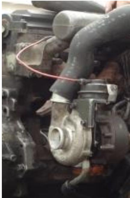
Fig. (49) Disposición del turbo con la manguera de aire comprimido y la válvula west gay en la maqueta didáctica, (Manuel Guerra, Adaptación del turbo, 2012)
