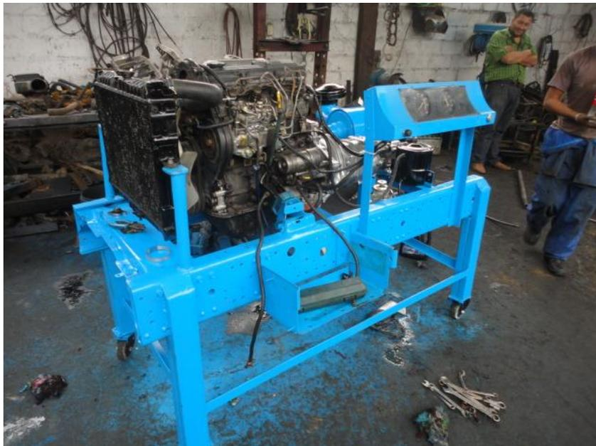
Fig. (51) Disposición del Motor incluido la adaptación del turbo de lado anverso listo para la donación a los talleres de la UTN, (Manuel Guerra, Motor listo, 2012)
