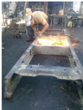
Fig. (44) Adaptación del chasis para el motor (Manuel Guerra, Creacion de la maqueta, 2012).
