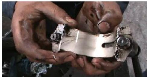
Fig. (41) Chaqueta de bancada del motor Kia Besta, (Manuel Guerra, Torque de Dial, 2012)
