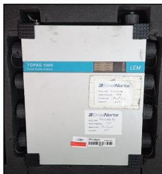
Fig. 8. Equipo analizador de red LEM TOPAS 1000.
