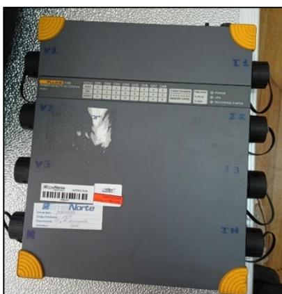
Fig. 6. Equipo analizador de red Fluke 1760.
