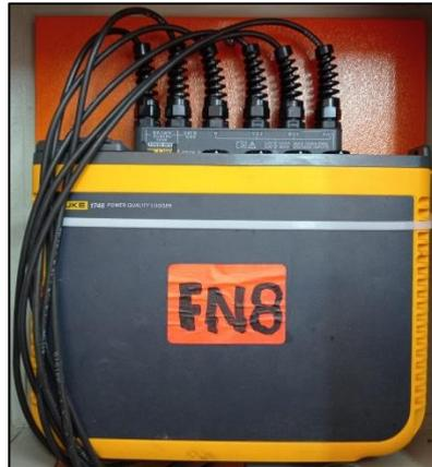
Fig. 5. Equipo analizador de red Fluke 1748.
