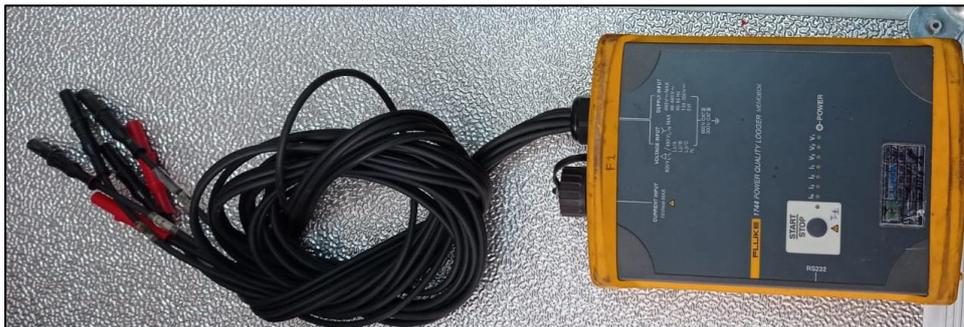
Fig.4. Equipo analizador de red Fluke 1744.
