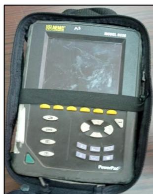
Fig. 7. Equipo analizador de red AEMC 8335. Fuente. Elaboración propia
