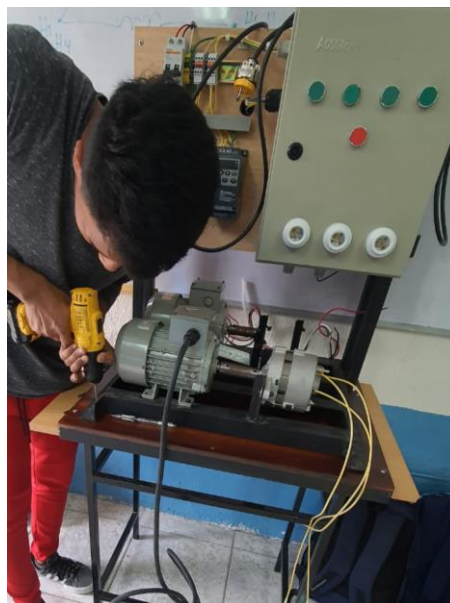
Fig. 55. Implementación del grupo motor-generator
