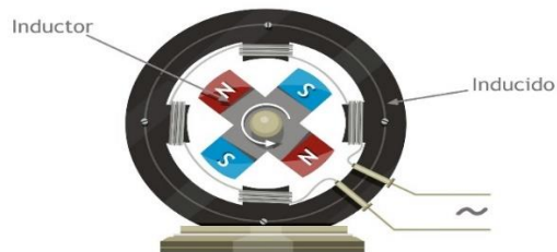
Fig. 1. Campo giratorio de un generador síncrono.
