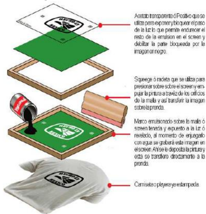
Figura 13 Preparación del marco de estampado
