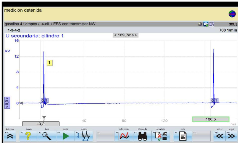
**FIGURA VII.13.** Oscilograma del tiempo de repetición de ciclo del secundario de la bobina a 690 rpm
