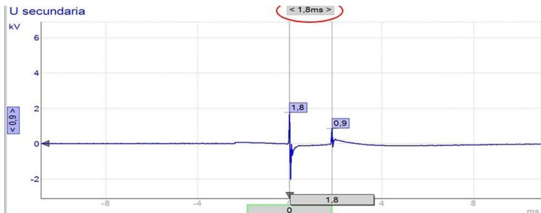
**Figura 3.23** Oscilograma del secundario con bujía descalibrada a 690 rpm
