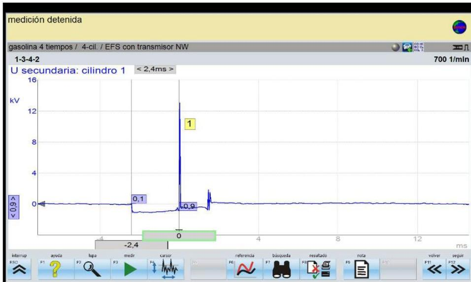
FIGURA VII.1. Oscilograma del tiempo de activación del secundario de la bobina a 690 rpm
