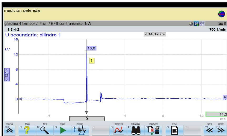
**FIGURA VII.4.** Oscilograma del voltaje de activación del secundario de la bobina a 690 rpm
