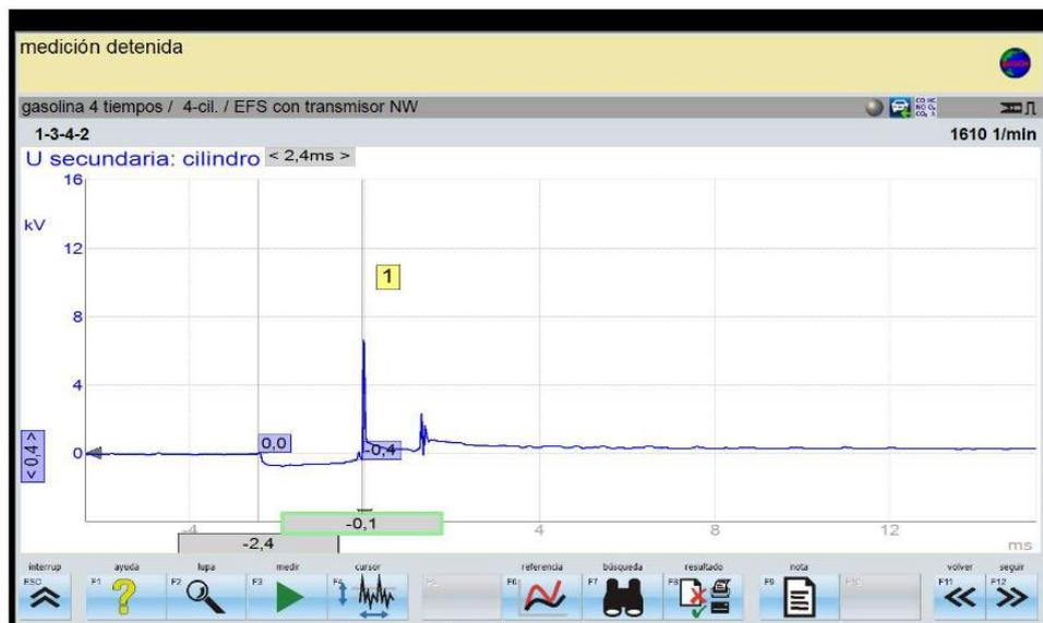
FIGURA VII.2. Oscilograma del tiempo de activación del secundario de la bobina a 1500 rpm
