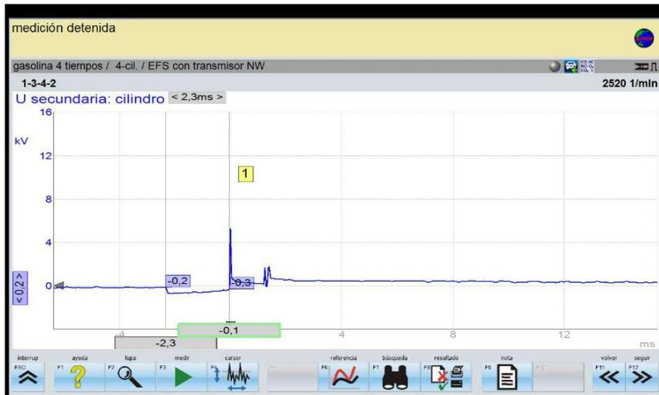
**FIGURA VII.3.** Oscilograma del tiempo de activación del secundario de la bobina a 2500 rpm
