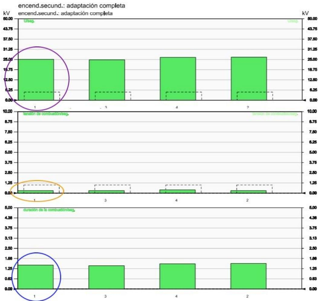
**Figura 3.20** Informe del secundario de la bobina en adaptación completa
