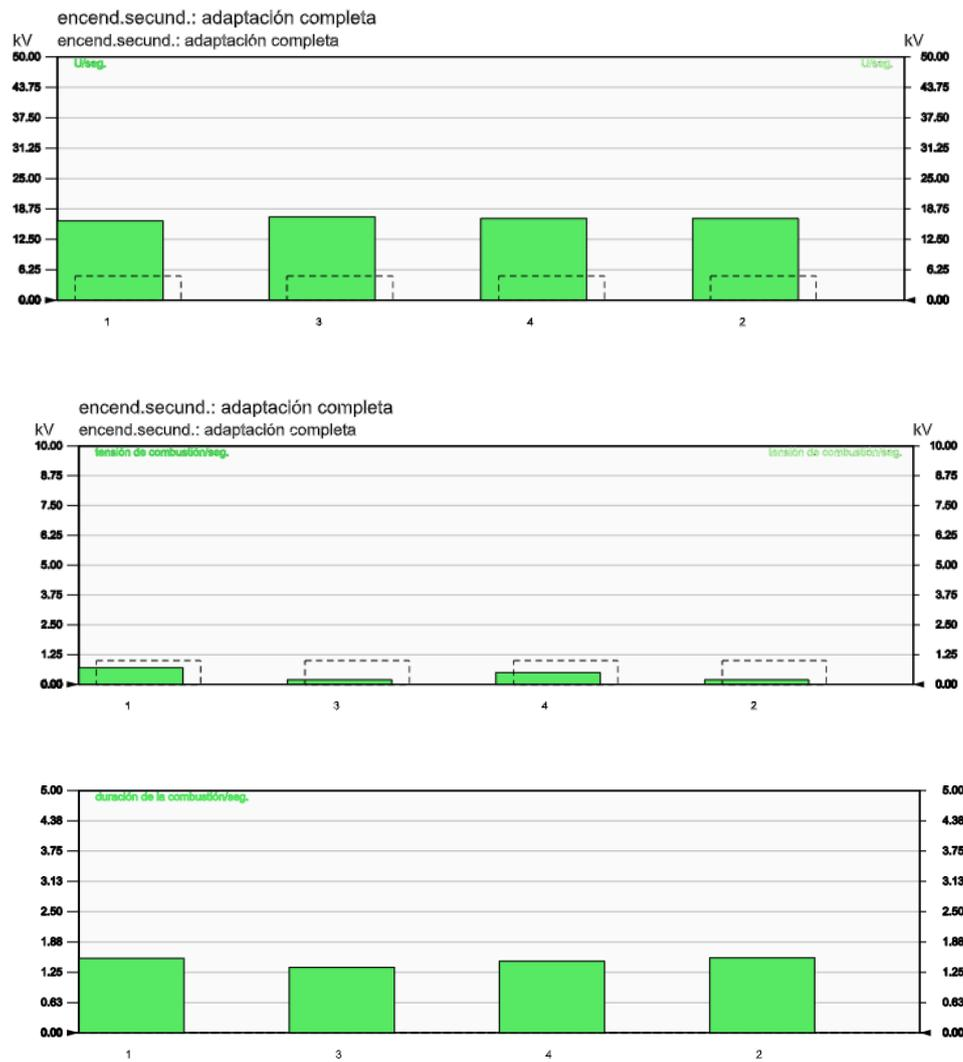
FIGURA VI.1. Medición adaptación completa bobinado secundario a 690 rpm
