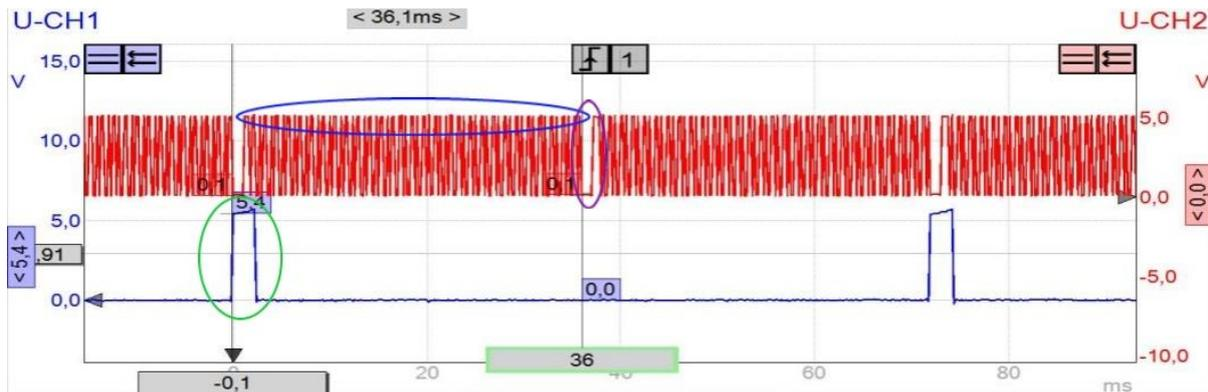
**Figura 3.13** Oscilograma de tensión del primario de la bobina y el sensor CKP
