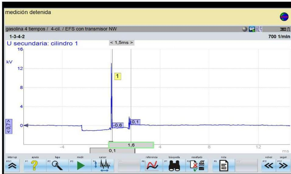
FIGURA VII.7. Oscilograma del tiempo de quemado del secundario de la bobina a ralentí
