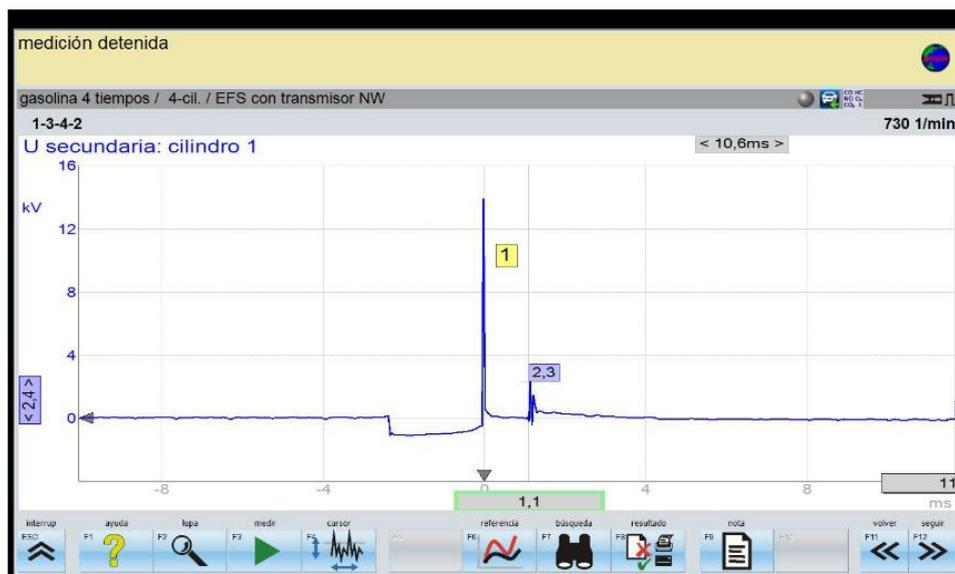
**FIGURA VII.10.** Oscilograma del voltaje de quemado del secundario de la bobina a 690 rpm
