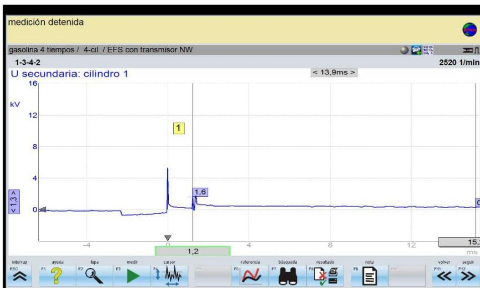
**FIGURA VII.12.** Oscilograma del voltaje de quemado del secundario de la bobina a 2500 rpm
