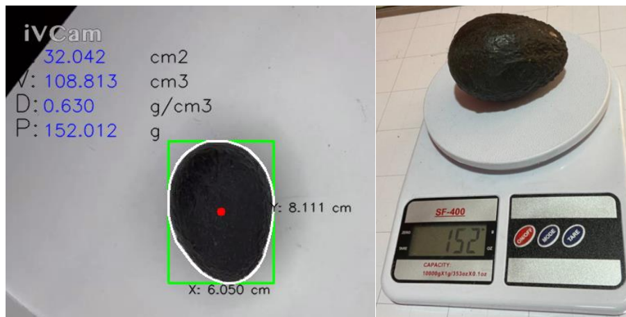
Figura 33 Pesos estimado por el algoritmo y la medición en balanza digital.
