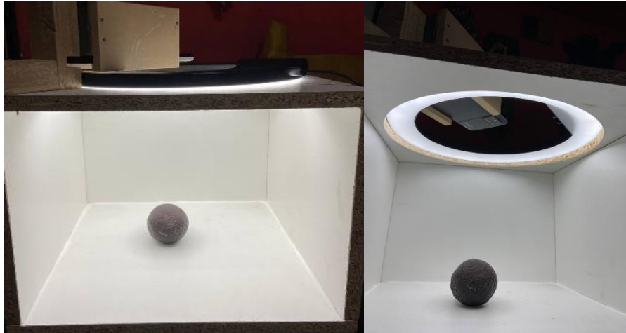
Figura 28 Colocación y funcionamiento del aro de luz led en el ambiente controlado.
