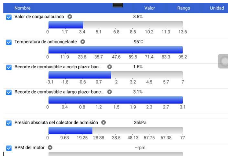
Figura 3. 29 Datos fase 4 Scanner automotriz vehículo KIA PICANTO Lx 2005
