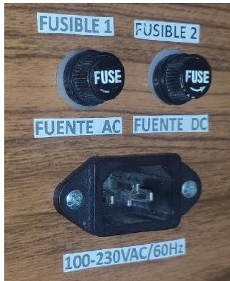
Figura 57. Protecciones eléctricas del prototipo CNC.
