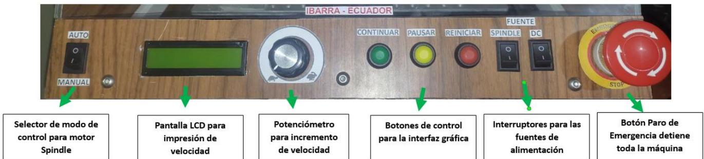
Figura 54. Tablero de control del prototipo.
