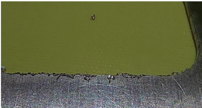
Figura 64. Resultado de corte a una velocidad de 45mm/min.
