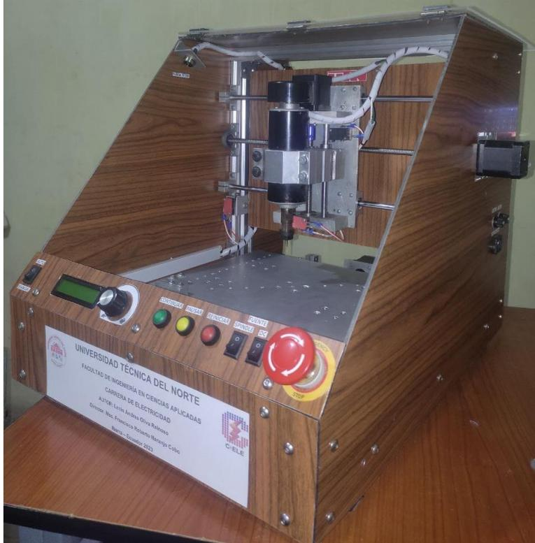
Figura 77. Prototipo CNC para la fabricación de prototipos PCB.
