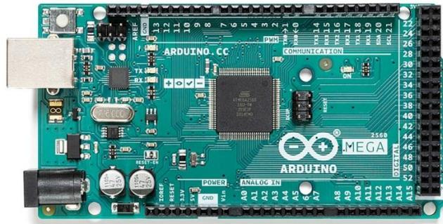
Figura 14. Arduino Mega 2560 Rev3.
