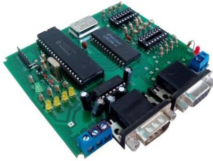
Figura 10. Microcontrolador ABServo CNC – USB/RS232.
