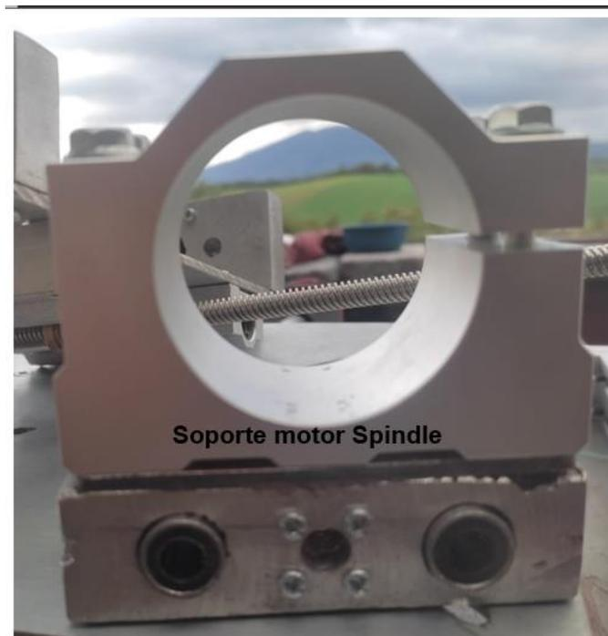
Figura 41. Ensamble del eje Z.
