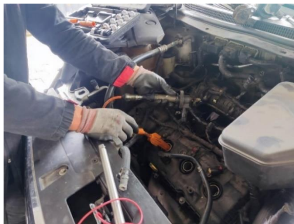
Figura 2.9 Prueba de comprobación de chispa
